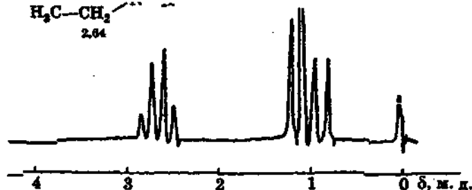
Рис. 69. ПМР-спектр диэтиламина ( J = 7 Гц)
